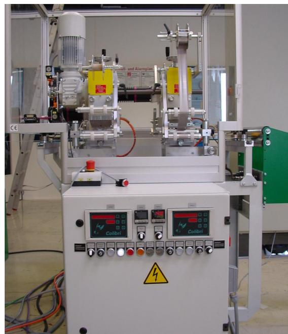
► Abb. Heißsiegelmaschine für Hologramme
