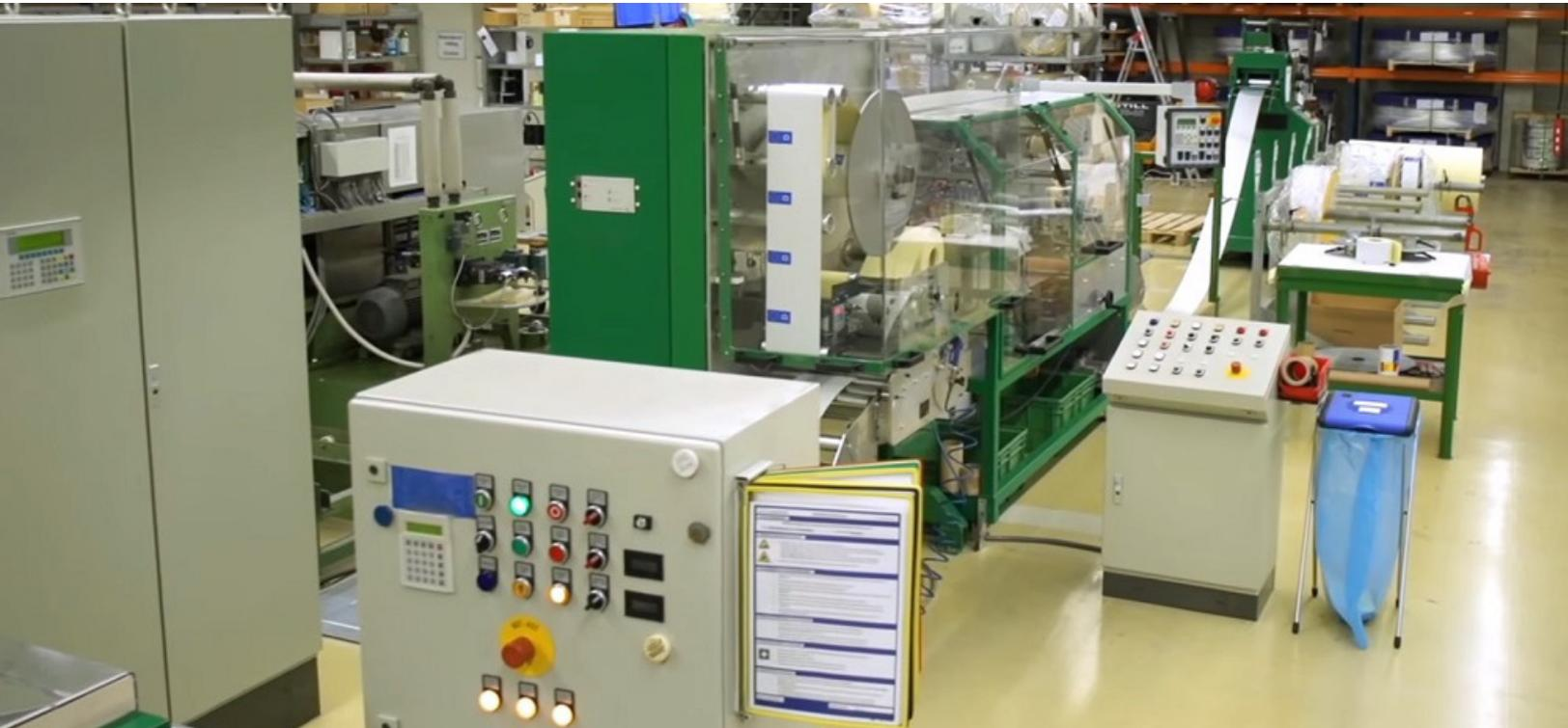
Die **vollautomatische Produktionsanlage** ist in der Lage Kfz-Platinen (Rohlinge für Kfz-Kennzeichen) mit reflektierender Folie ohne Grafik als auch mit Grafik für ein- und zweizeilige Kfz-Kennzeichen herzustellen. Die genaue Kennzeichengröße (Länge und Breite) wird durch das jeweilige Werkzeug in der Presse bestimmt.
