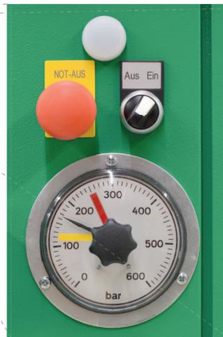
Am Manometer des Druckschaltgerätes kann der Arbeitsdruck (die Prägekraft) stufenlos bis 250 bar (50 t) eingestellt werden.
